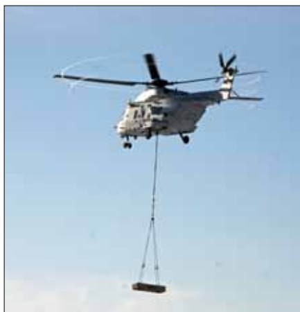
Flyga med hängande last är en av de nya funktionerna för HKP14 D. Foto: Lasse Jansson/Försvarsmakten.
