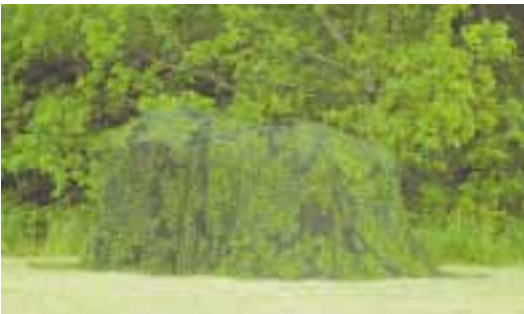
Terrängbil maskerad med IR-dämpande maskeringsnät
