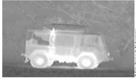
Terrängbilen som den upplevs i ett IRV-sikte (värmekamera/passiv IR). Det mörka fältet på terrängbilens övre vänstra del är målat med IR-dämpande färg
