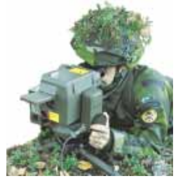
Avståndsmätning med e-trupplaseravståndsinstrument
