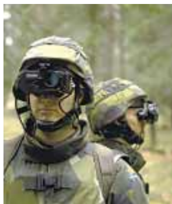
Exempel på bildförstärkare s k "Goggles" som fästes på huvudet eller på hjälmen
